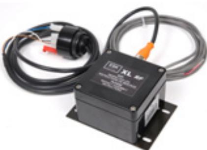
Il rilevatore d'urto indipendente è un rilevatore d'impatto che può essere montato su qualsiasi veicolo adibito alla movimentazione dei materiali. Se il veicolo subisce una collisione che supera il presente livello di impatto, viene emesso un allarme acustico per segnalare al supervisore che si è verificato un incidente.
