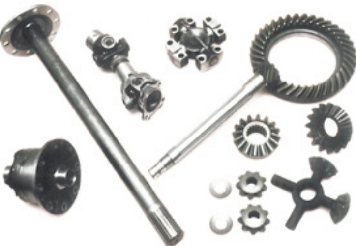
Componentes: engranaje de anillo y piñón, caja y engranaje, arandelas, eje motriz, ejes, cojinetes, sellos, cajas, juntas en U...
