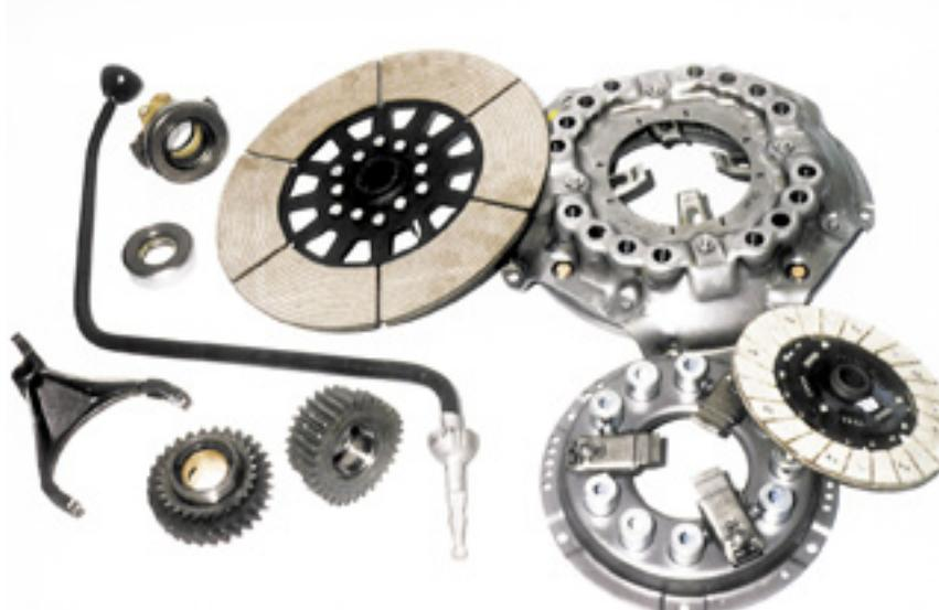
Componentes: placas, discos, cojinetes de empuje, kits de sellado, engranajes, horquillas, ejes...
