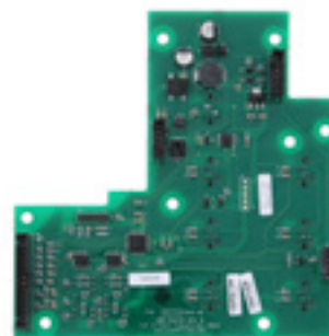
Montaje de tarjeta lógica (controlador de plataforma)
