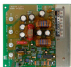
Convertidor paso a paso 12-48 V
