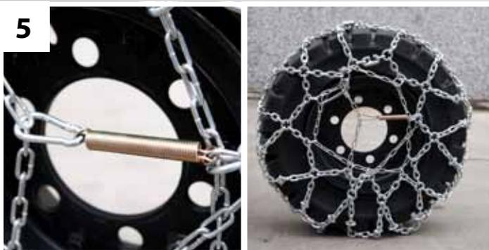
Coloque o tensor da corrente ao redor da roda e enganche este em algum lugar de posição contrária à um elo da corrente, mas mantenha a tensão com o tensor da corrente através da mola tensora. É permitida a redução da tensão da corrente, fazendo com que se tenha um comprimento mais aceitável e depois utilizando o gancho prendedor e a mola encaixar mais elos utilizando os elos de reposição de reserva.
