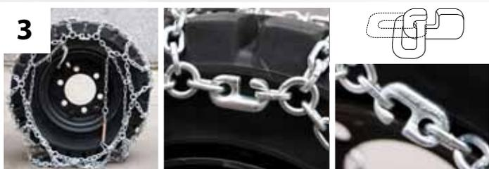
Coloque a corrente ao redor do pneu e prenda os ganchos no elo oposto correspondente, como na imagem. ATENÇÃO: O elo da corrente deve ser preso transversalmente nos ganchos especiais. Por causa desses ganchos especiais nós evitamos a possibilidade da perda do comprimento do elos da corrente. Pode-se dirigir em terreno com neve se esses ganchos se encontram na superfície do pneu.
