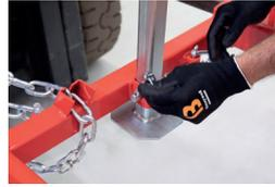
6. Retirez la goupille fendue, soulevez la goupille, faites tourner la lame et bloquez la lame avec la goupille de verrouillage.
