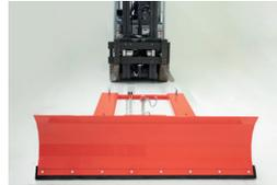
4. Sécurisez avec la chaîne et serrez bien les vis sur les fourreaux de fourche. Assurez-vous que la lame à neige ne peut pas glisser des fourches.
