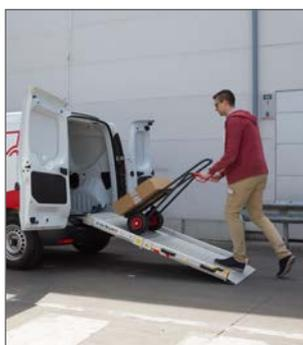
6. À la fin du travail, fermez et sécurisez la rampe en utilisant tous les systèmes de sécurité. Avant de quitter, serrez toujours la sangle de sécurité pour sécuriser la rampe.
