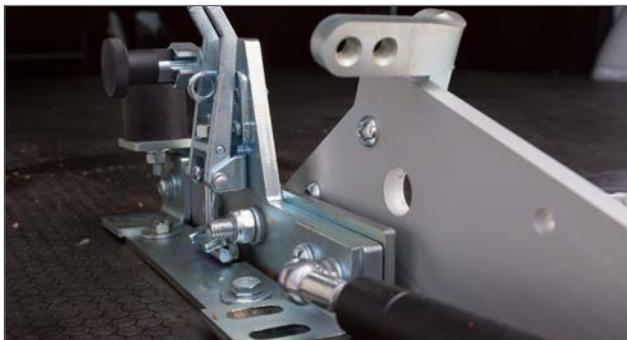
4. Ouvrez la rampe avec la poignée et débloquez le patin de sécurité en caoutchouc à gauche de la rampe.
